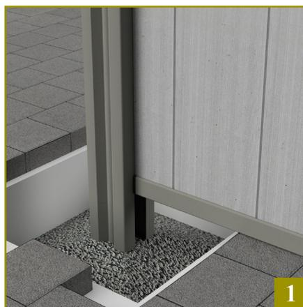
**Possibilité 1:** Les planches s'insèrent directement dans le profilé DF1UA2833 + DF1SUPT qui repose directement sur le support plat et dur. Cela n'est possible que si la surface est solide (dalles de terrasse ou sol en béton).
