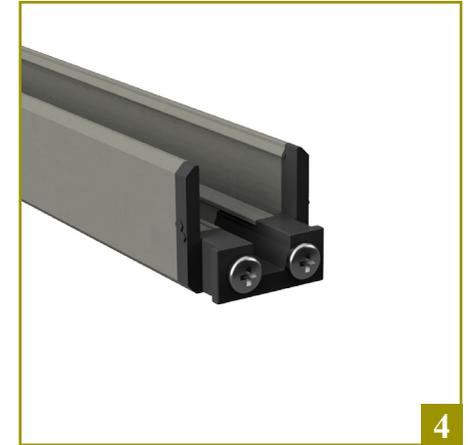
Pour une installation verticale, le profilé haut (réf. DF1UA2833) doit être raccourci de façon à ce que sa longueur soit inférieure de 20 mm à la distance entre les poteaux (standard 1960 mm).
