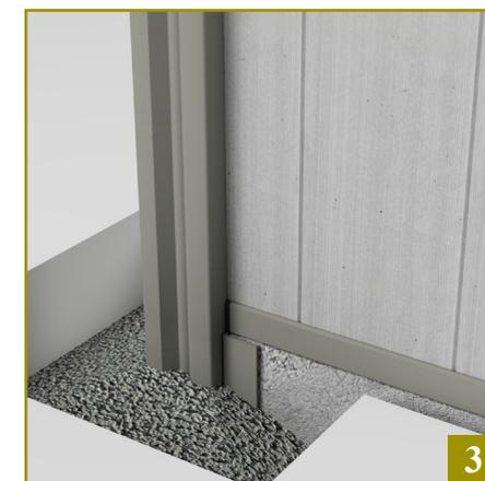
**Possibilité 3:** Les planches sont soutenues par une dalle de soubassement en béton au même niveau que le sol ou au-dessus de celui-ci.
