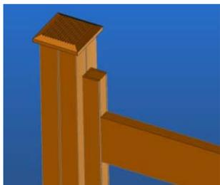
Veillez à ce que le profilé en U dépasse de quelques cm la planche supérieure. Glissez y un dernier petit bloc de profilé intercalaire. Le poteau doit dépasser le haut de la clôture de quelques cm afin d'assurer un espace suffisant pour la dilatation. Assurez-vous que le joint de dilatation (min. 1cm) soit suffisant de chaque côté des planches. Evitez d'endommager les planches.
